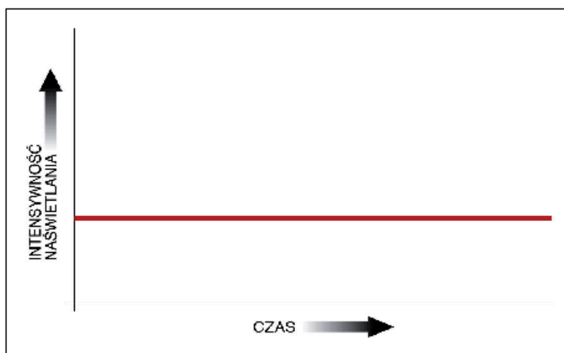
Rycina 1. Graficzny schemat przebiegu fotopolimeryzacji ciągłej
