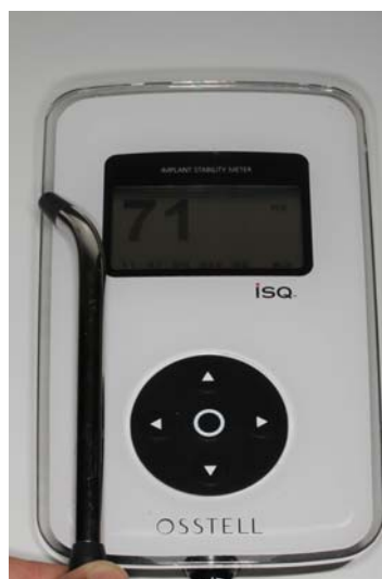
Rycina 10. Pomiar pierwotnej stabilizacji implantu za pomocą przyrządu Osstell ISQ meter
