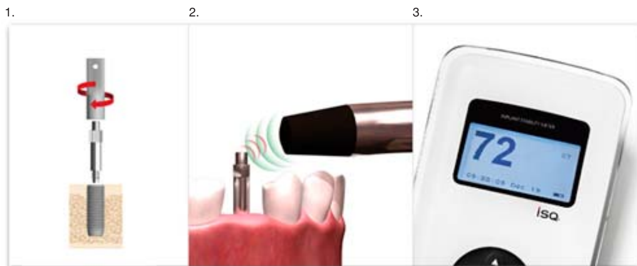
Rycina 1. Instrument do badania stabilności implantów Osstell. 1 – końcówka SmartPeg umieszczona w wewnętrznym gwinciu implantu; 2 – wysyłanie impulsów magnetycznych z Osstell do SmartPegu; 3 – poziom stabilności implantu w skali ISQ ( Implant Stability Quotient )
