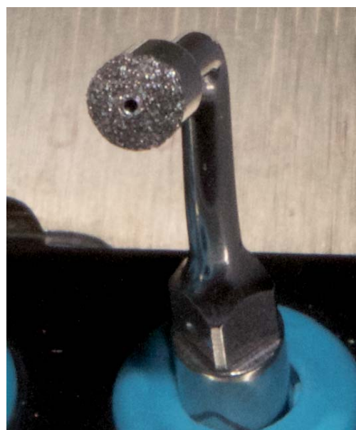
Rycina 4. Końcówka główna z chłodzeniem wewnętrznym
