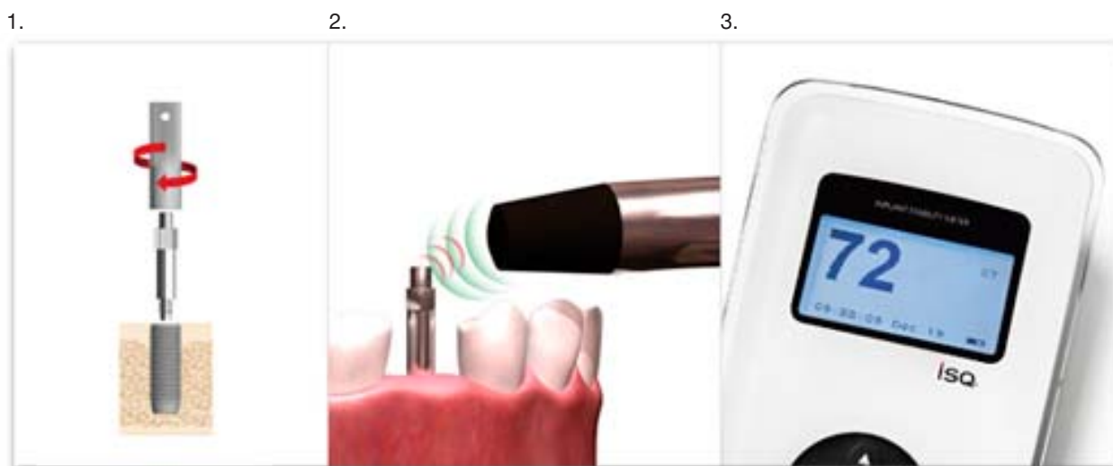
Rycina 1. Instrument do badania stabilności implantów Osstell. 1 – końcówka SmartPeg umieszczona w wewnętrznej gwincie implantu; 2 – wysyłanie impulsów magnetycznych z Osstell do SmartPegu; 3 – poziom stabilności implantu w skali ISQ ( Implant Stability Quotient )
