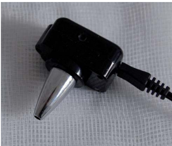
Rycina 1. Końcówka wibratora, za pomocą której badano implanty i zęby
